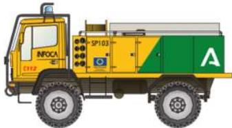
Los vehículos autobomba permiten llevar el agua hasta las proximidades del fuego y lanzarla a presión sola o mezclada con productos retardantes por medio de mangueras.
