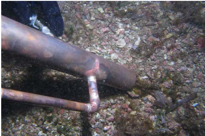
Foto 3. Aspirador submarino utilizado para la erradicación de Caulerpa racemosa (Punta Javana, -23 m).
