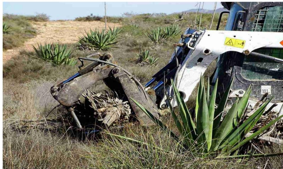
**Figura 2:** Minicargadora de ruedas tipo "Bodcat" trabajando en la erradicación de sisal de la zona sur del del tajo. (05/11/2021)
